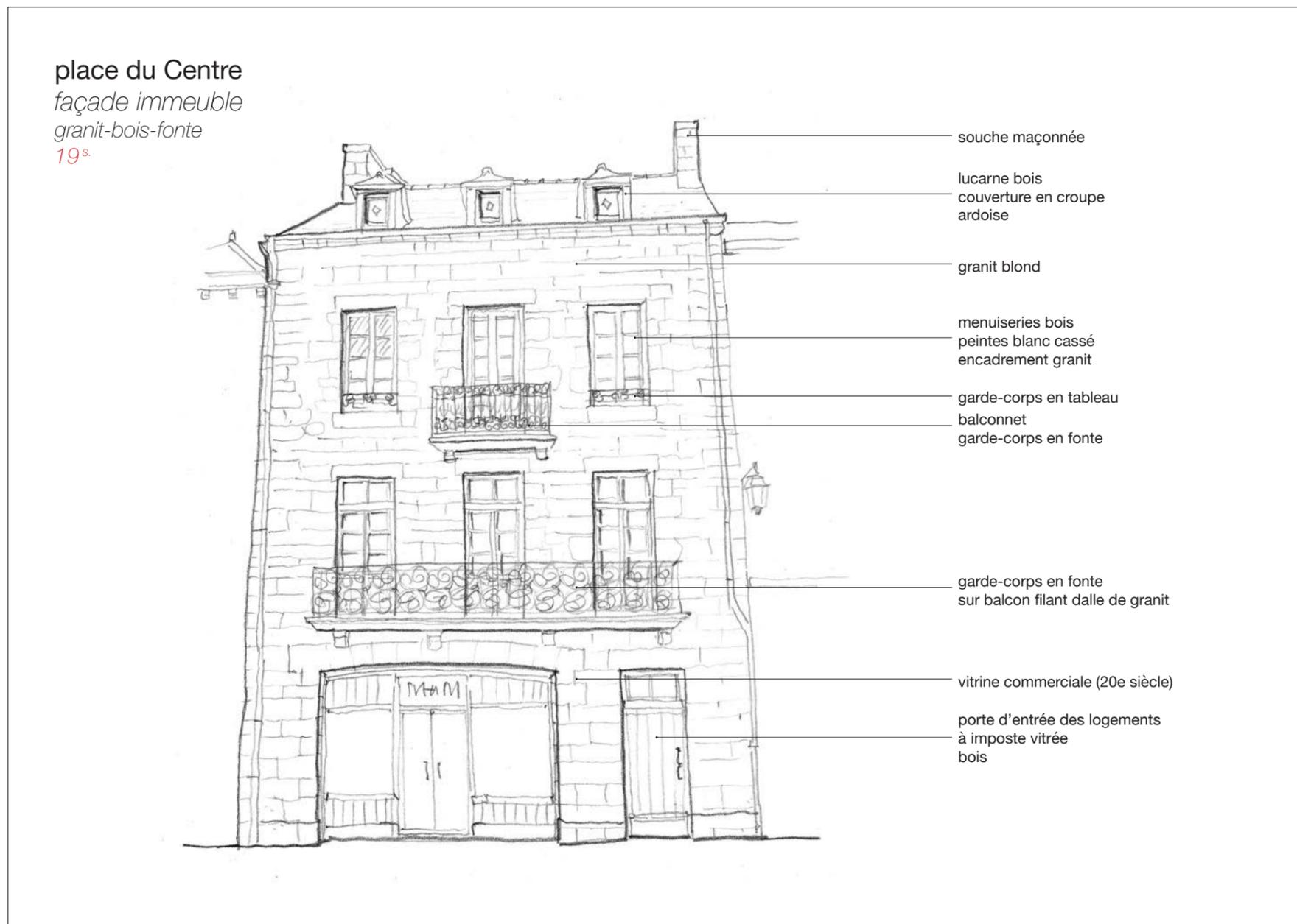
Fig. 290 : Façade d'immeuble 19<sup>ème</sup> en granit, bois et fonte - Place du Centre
