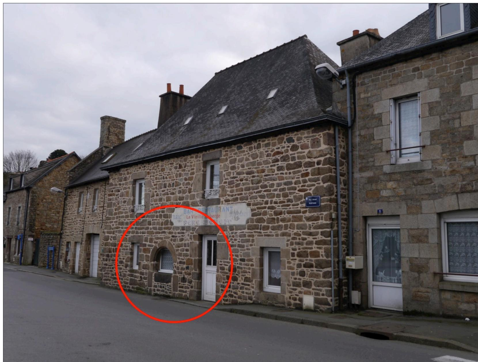
Fig. 271 : La régularisation de la pente de la chaussée de l'actuelle route de Corlay (au Rustang) a entraîné la création de nouvelles ouvertures de ce bâtiment, l'entrée actuelle se pratiquant soit par le surhaussement du plancher, soit par l'intégration de marches intérieures récupérant le niveau initial.
