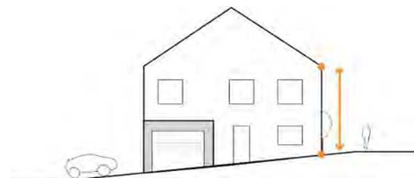
Figure 33 : Méthode de calcul des hauteurs
