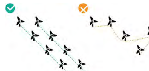
Figure 47 : Implantation linéaire des éoliennes
